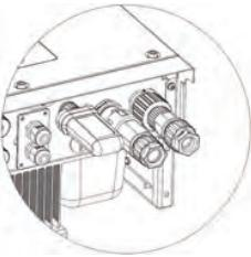
将GPRS设备插入逆变器的WiFi/GPRS接口，并拧紧。
